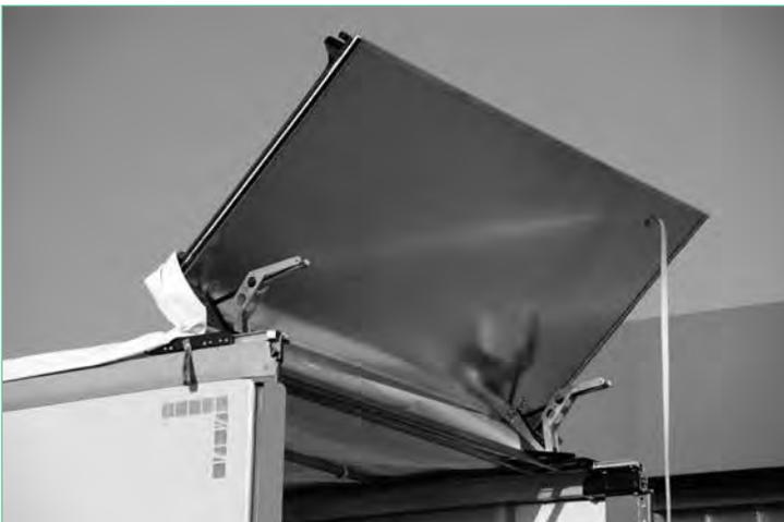
Halbautomatisch aufschwingende Heckabschlussklappe für Fahrzeuge mit Schiebeverdeck und Ladebordwand
