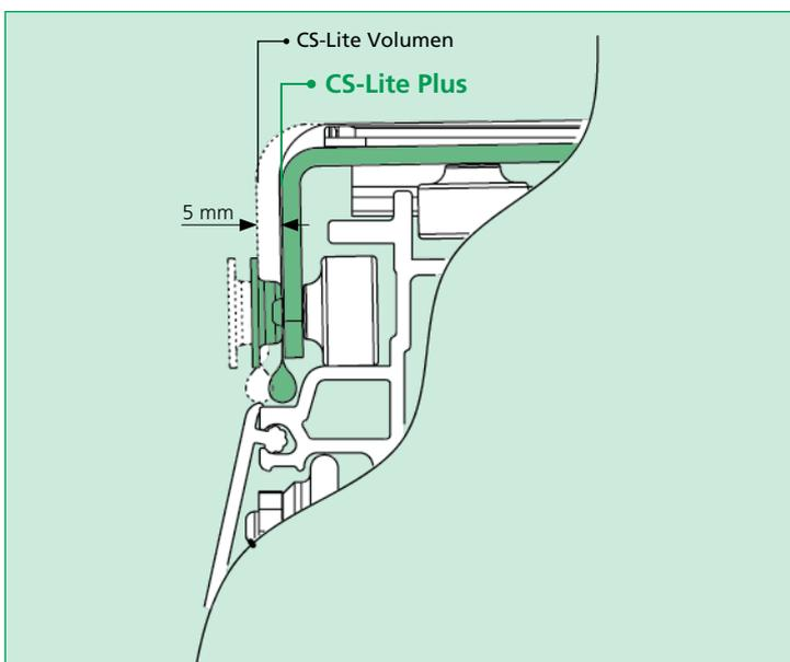
Seitlich zurückversetzte Dachplanenbefestigung zum Schutz vor Beschädigung (Nur für CS-Lite Plus 125 und CS-Lite Plus 175)
