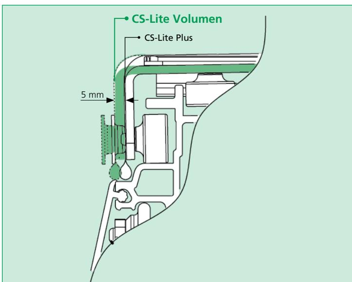
Seitlich zurückversetzte Dachplanenbefestigung zum Schutz vor Beschädigung (Nur für CS-Lite Volumen 125 und CS-Lite Volumen 175)
